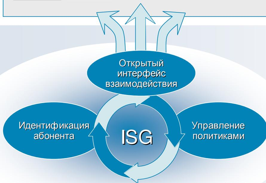
Cisco Intelligent Services Gateway (ISG) – это лицензируемый функционал маршрутизаторов Cisco, обеспечивающий управление сессиями, политиками и сервисами для различных сетей доступа
